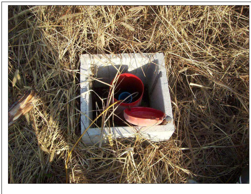
Sondaggio geognostico S1 attrezzato con piezometro a tubo aperto (da elaborati di progetto 3° lotto).
